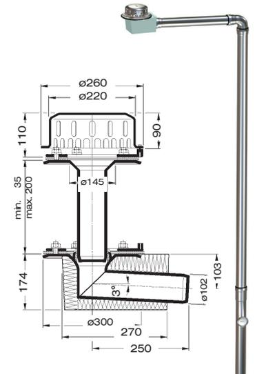
mit Wärmedämmung und Heizung
